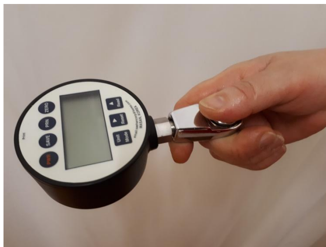
7. ábra – Az aktív kulcsfogás erejének mérése Seahan Corporation Digi Pinch készülékkel
