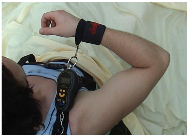
5. ábra – Az aktív könyöknyújtás erejének mérése a beteg testére rögzített heveder és JVS elektromos skála segítségével
