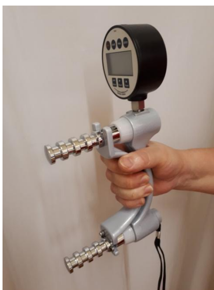
6. ábra – Az aktív markolás erejének mérése Seahan Corporation Digi Hand Dynamométerrel
