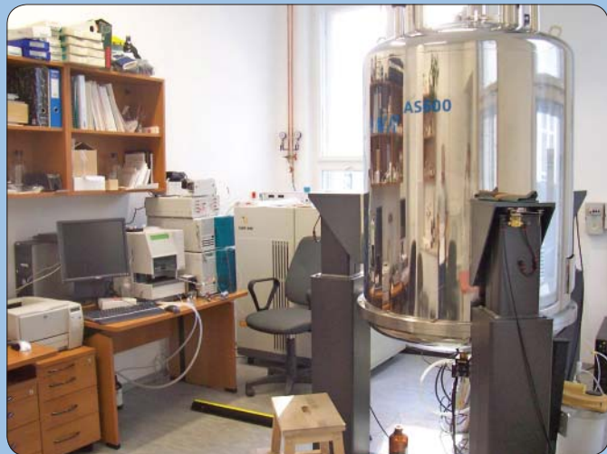
■ Bal oldalon a folyadékkromatográf (HPLC) és a vezérlő számítógép, jobb oldalon az NMR készülék mágnesa
