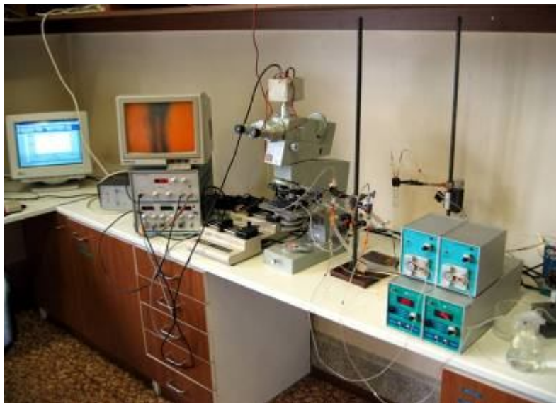
Az Érbiomechanikai laboratórium számítógépes videomikroszkóppal és feedback-szabályozott mikropumpákkal
