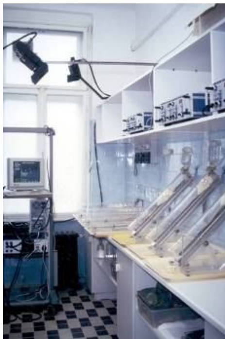
Tílt-laboratórium mozgáskövető berendezéssel: ortosztatikus jellegű gravitációs terhelésnövelés a hátsó végtagi vénákra (Az „inverz-ortosztázis” a mikrogravitás modelljéül szolgál.)
