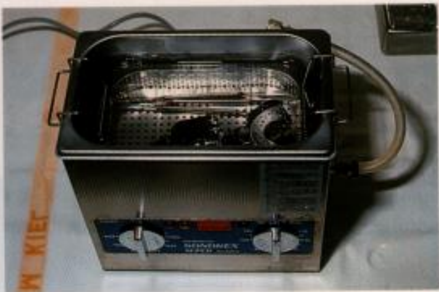
Ultraschallbad mit Desinfektionsmittel
