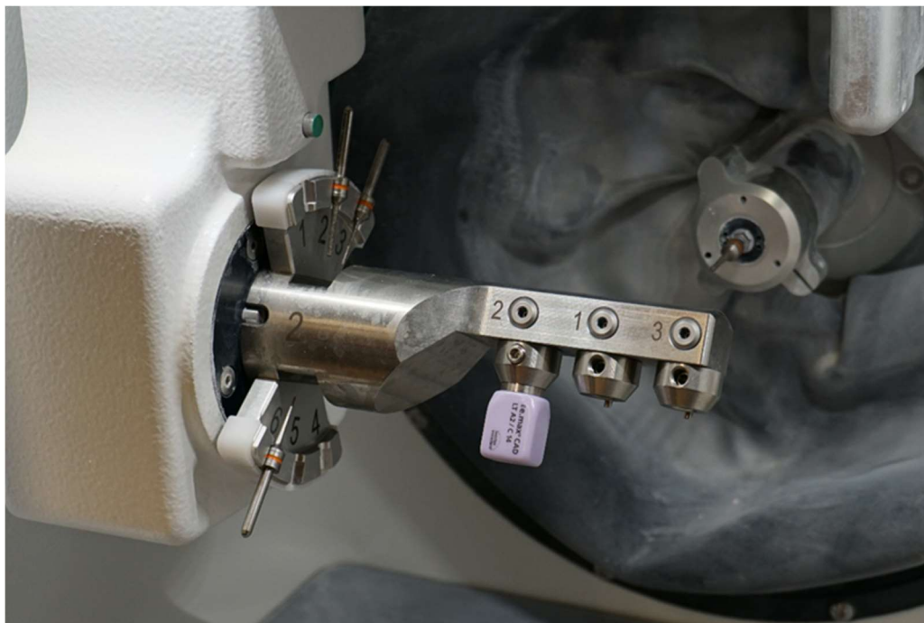
5. ábra Lítium-diszilikát üvegkerámia tömb a marógységbe helyezve (a szerző saját ábrája)
