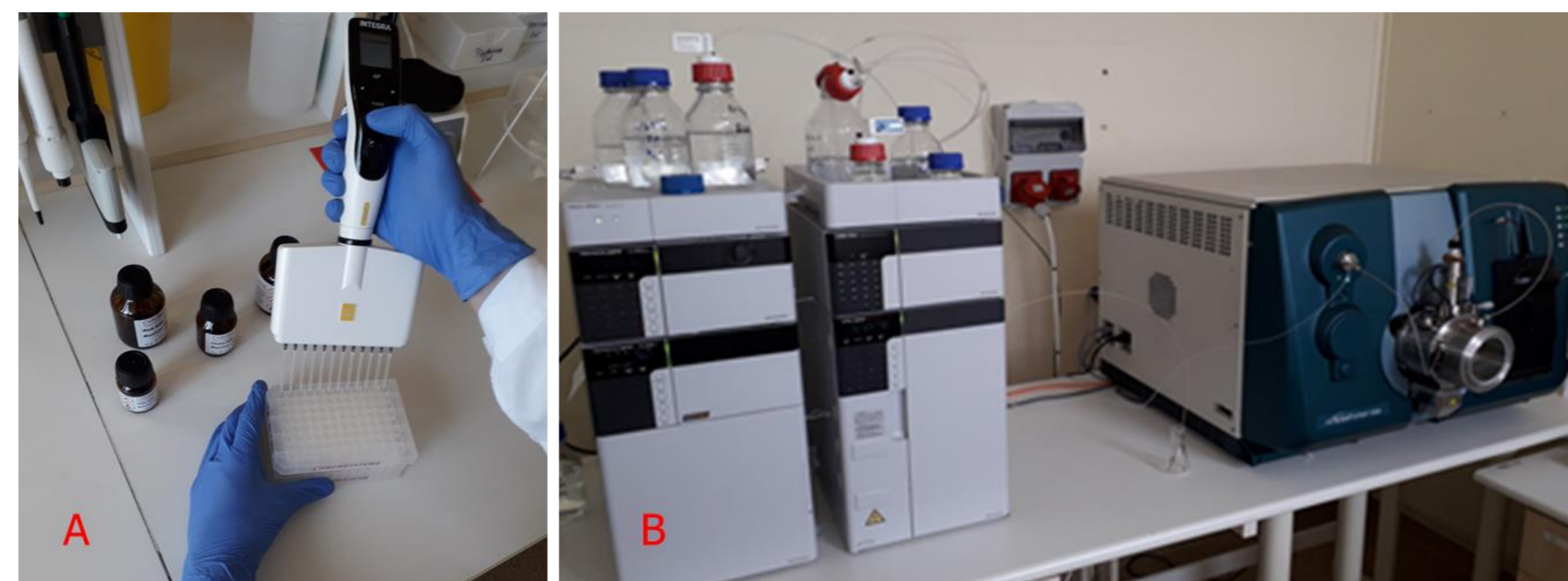
3. ábra Plazma metanefrinek mérésénél alkalmazott eszközök, berendezések. A: Manuális minta-előkészítés nagy átteresztőképességű eljárás; B: Shimadzu Nexera XR-Sciex Qtrap 5500 HPLC-MS/MS mérőrendszer (elektrospray ionizációhoz konfigurálva)
