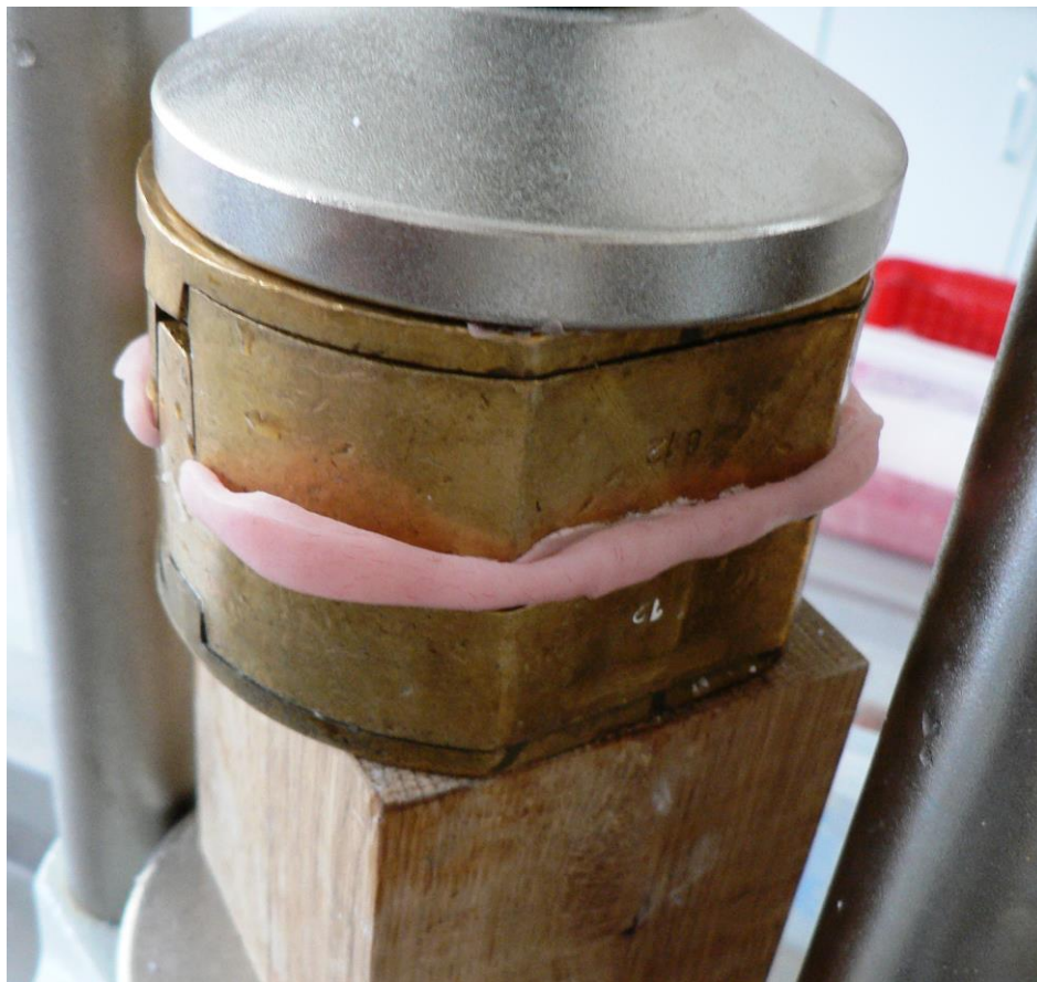
Fordított beágyazás esetén préseléskor a fölösleges akrilát kipréselődik a küvettafelek között
