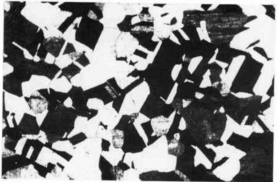
Abb. 2.16 Schliffbild von reinem Gold. 25fache Vergrößerung. (Photo: Cendres & Métaux, S.A., Biel, Schweiz)
