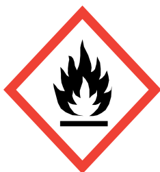
GHS02 tűzveszélyes flammable
