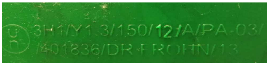
5.2.1. ábra: Vegyi veszélyes hulladék gyűjtésére szolgáló csomagoló eszköz (műanyag kanna) UN jelölése.
